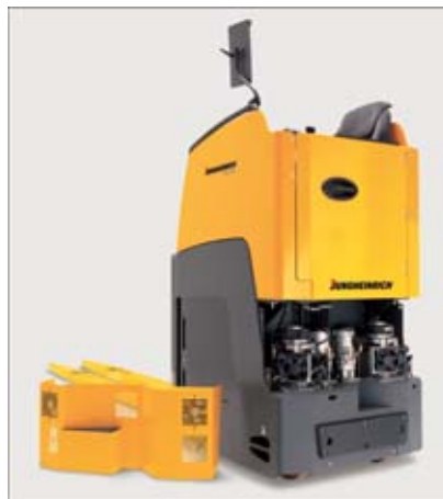
Componenti facilmente raggiungibili attraverso sportelli di ispezione
