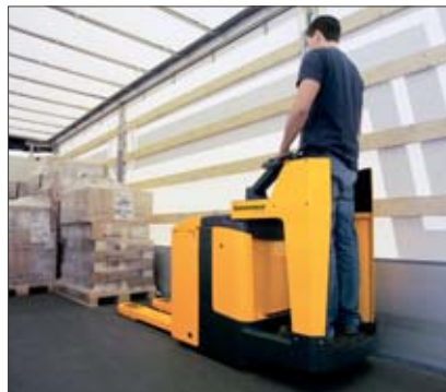
Posto operatore protetto grazie alla piattaforma fissa
