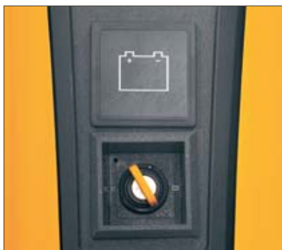
Controllo scarica con indicatore stato di carica batteria
